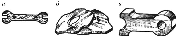
Рис. 2.97. Детали, имеющие фасонные поверхности
