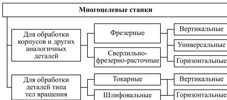
Рис. 4.7. Классификация многоцелевых станков
