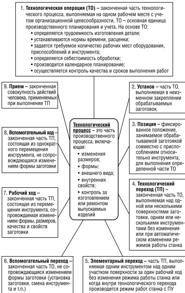
Рис. 1.1. Элементы технологического процесса
