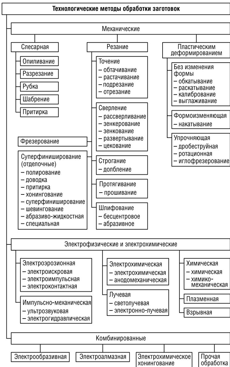
Рис. 2.1. Технологические методы обработки заготовок
