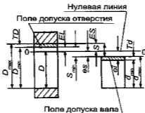
Рис. 2.7. Характер расположения полей допусков в посадке
