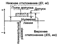
Рис. 2.2. Поля допуска: вала ( ES, es ); отверстия ( EI, EI )
