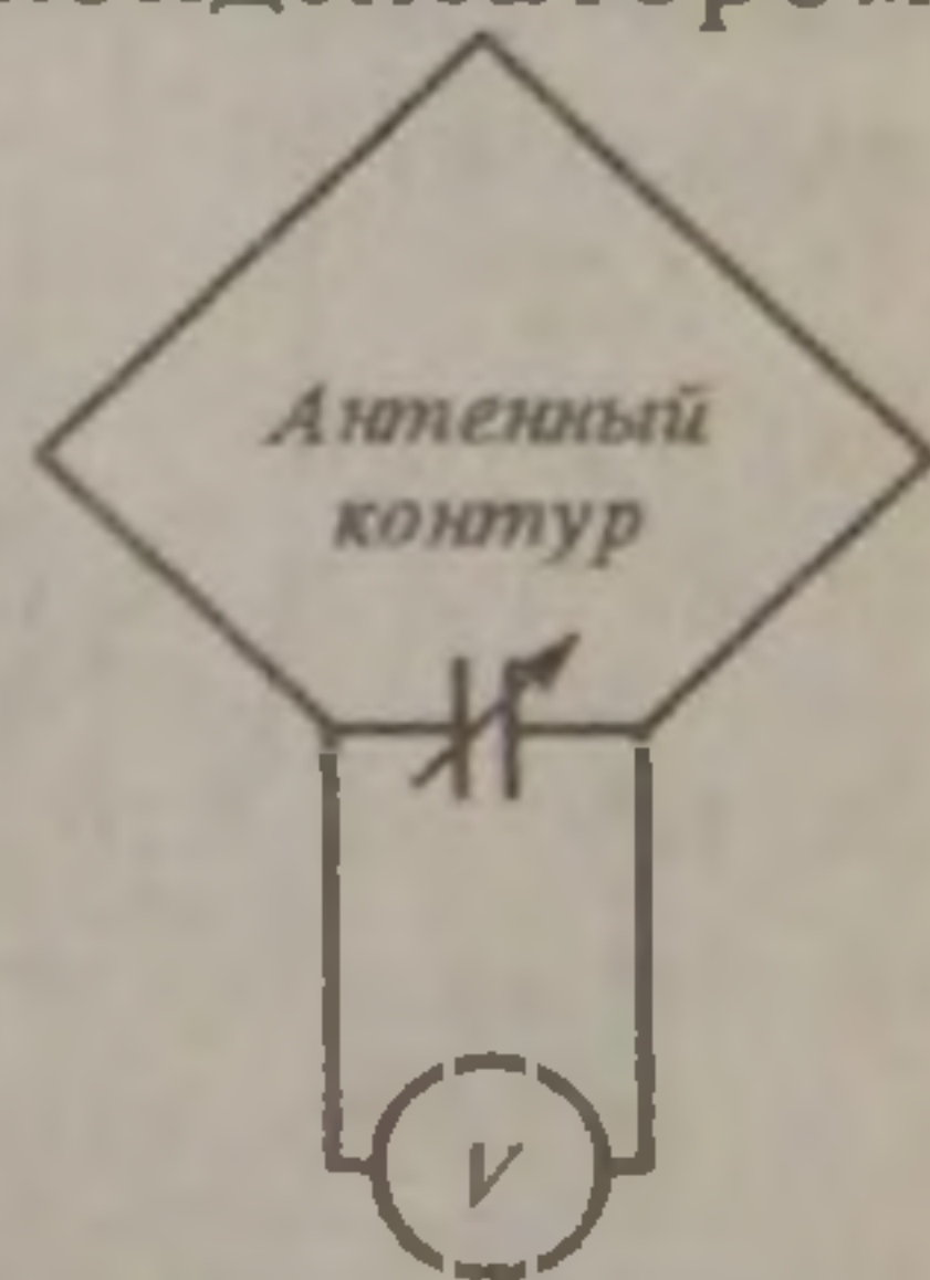
Рис. 8.2. Измерение напряженности поля методом непосредственной оценки
