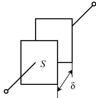
Рис. 2.20. Конструкция конденсатора
