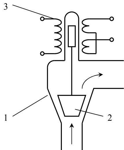
Рис. 4.17. Ротаметр: 1 – конический участок трубы; 2 – поплавок; 3 – датчик перемещения
