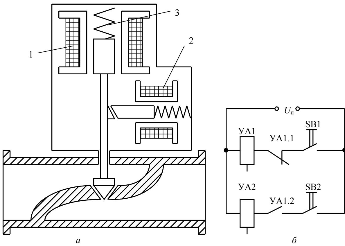
Рис. 2.52. Электромагнитный клапан с защелкой:
