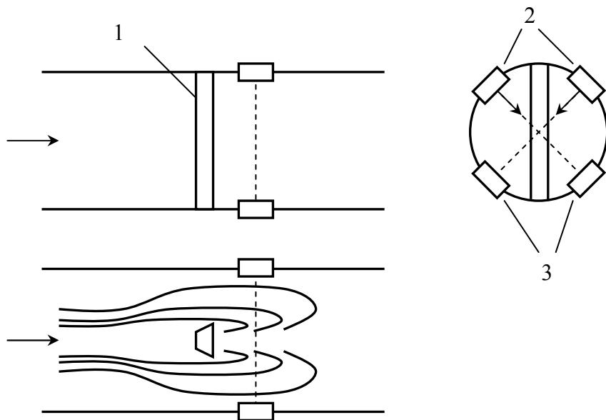
Рис. 4.22. Вихреакустический расходомер
