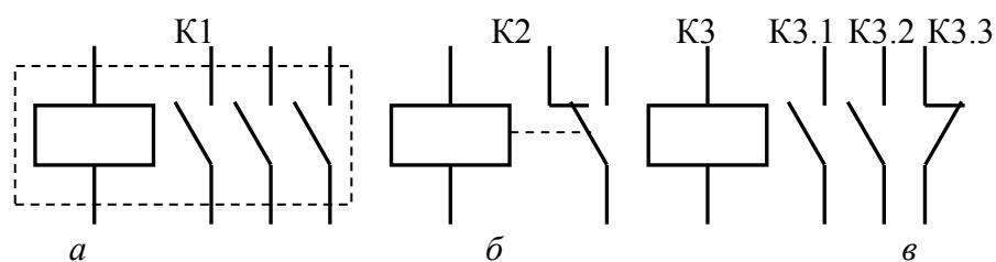
Рис. 2.37. Изображение реле на схеме:
