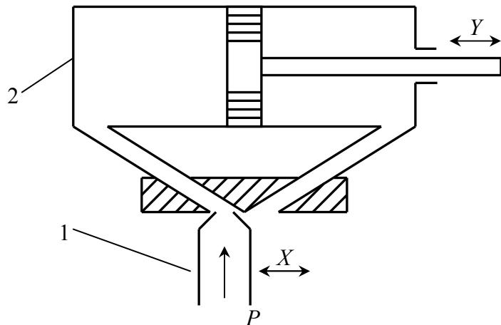
Рис. 2.49. Струйный гидравлический усилитель
