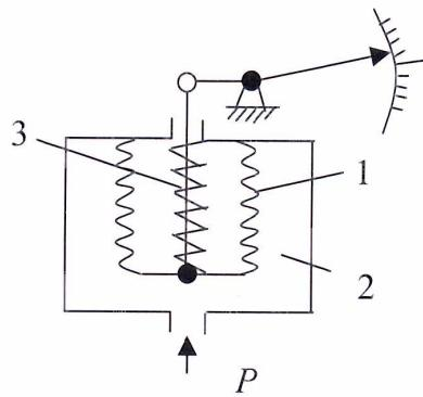
Рис. 4.12. Сильфонный манометр
