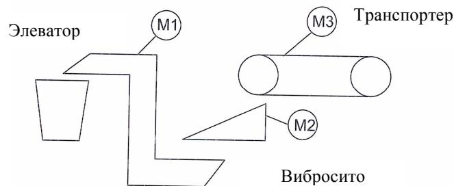
Рис. 6.9. Поточно-транспортная система
