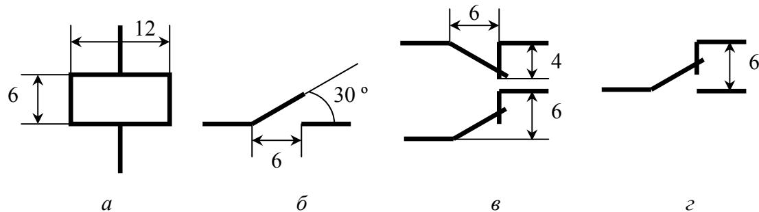
Рис. 2.36. Обозначения элементов реле на схемах:
