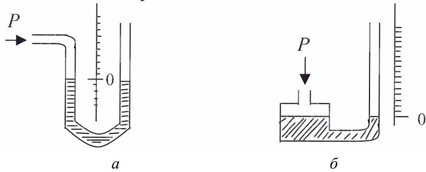
Рис. 4.8. Жидкостные манометры: *a* – *U*-образный; *b* – чашечный
