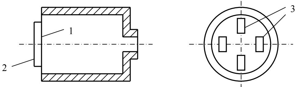
Рис. 4.15. Датчик давления с тензопреобразователем:
