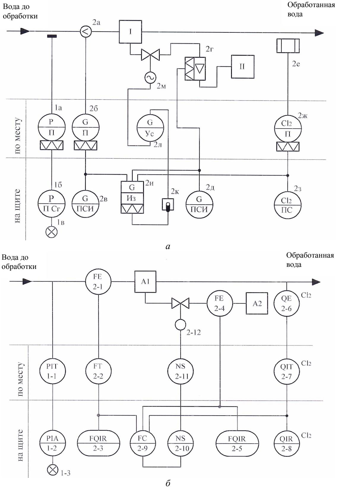
Рис. 3.2. Функциональная схема автоматизации установки хлорирования воды:
