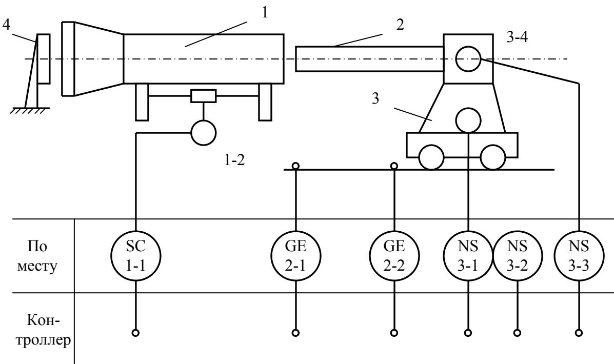
Рис. 6.21. Функциональная схема автоматизации установки для изготовления труб
