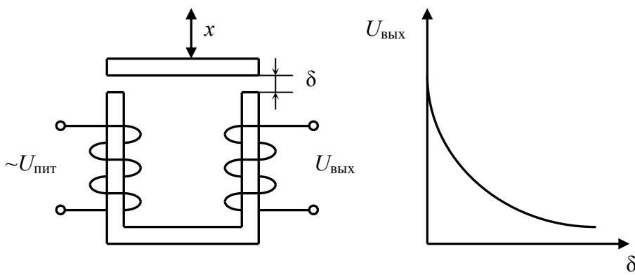
Рис. 2.18. Конструкция (а) и характеристика (б) трансформаторного датчика
