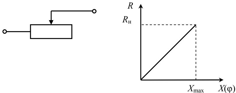
Рис. 2.3. Схема реостатного включения датчика и его характеристика
