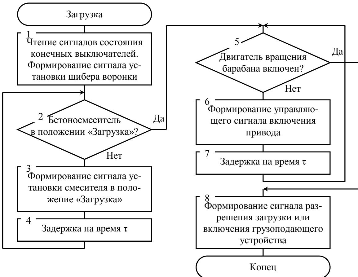
Рис. 6.17. Схема алгоритма управления смесителями в режиме загрузки
