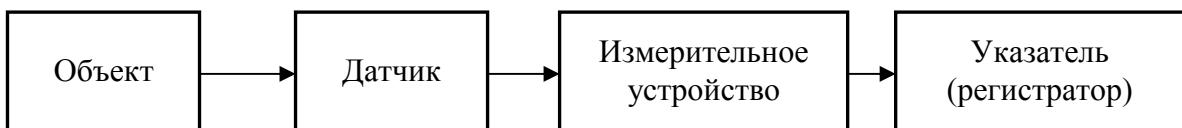
Рис. 1.1. Структурная схема системы автоматического контроля
