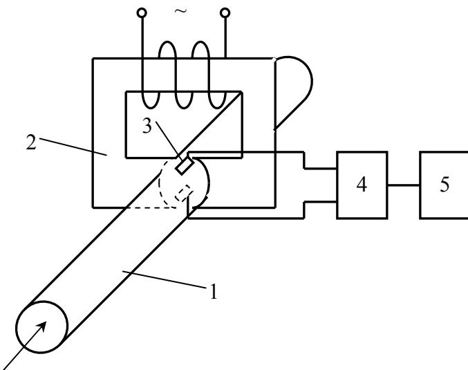
Рис. 4.20. Схема электромагнитного индукционного расходомера:
