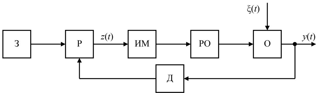
Рис. 5.4. Структурная схема замкнутой САР
