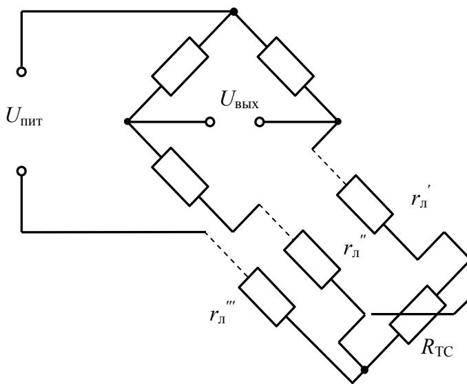
Рис. 4.5. Схема соединения термометра сопротивления с мостом
