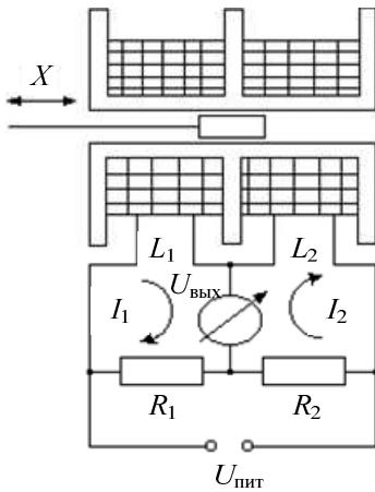
Рис. 2.17. Дифференциальный индуктивный датчик, включенный в мост
