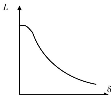
Рис. 2.13. Характеристика индуктивного датчика
