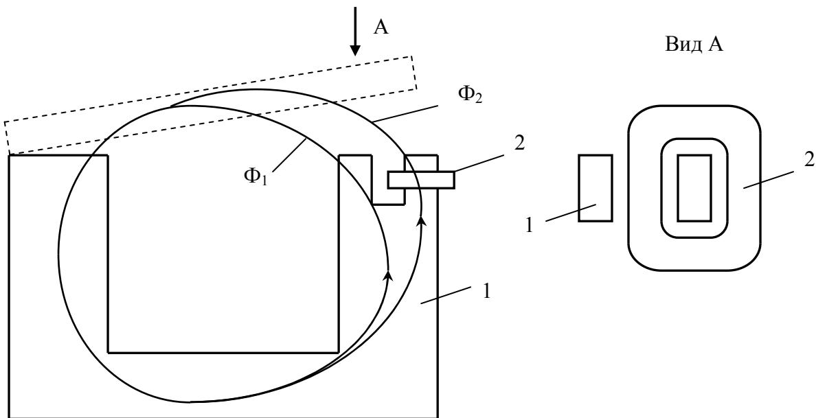
Рис. 2.33. Сердечник реле переменного тока:
