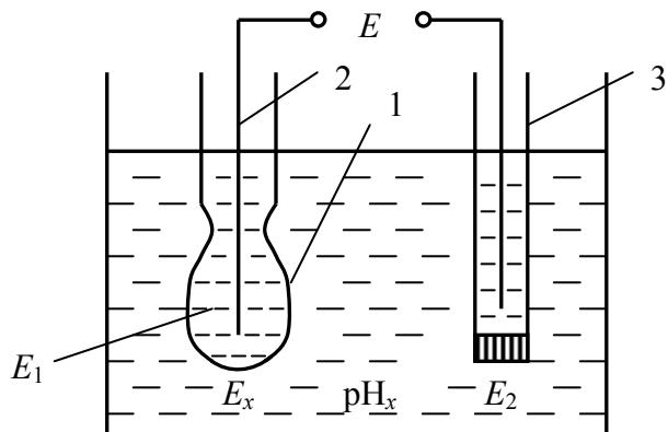
Рис. 4.32. Схема измерения pH
