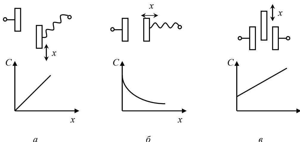
Рис. 2.21. Конструкции и характеристики емкостных датчиков с различными изменямыми параметрами:
