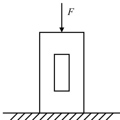
Рис. 2.7. Схема наклеивания тензодатчика на колонну
