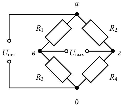
Рис. 2.9. Схема моста
