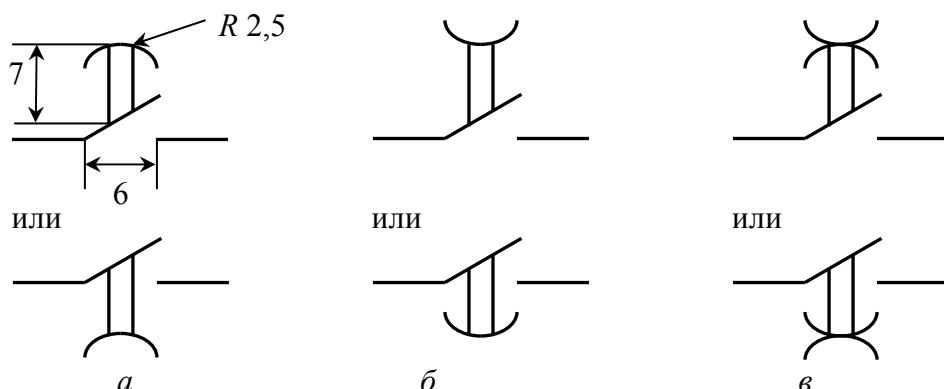
Рис. 2.41. Условные графические обозначения замыкающих контактов реле времени:
