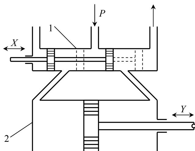
Рис. 2.48. Гидравлический золотниковый усилитель:
