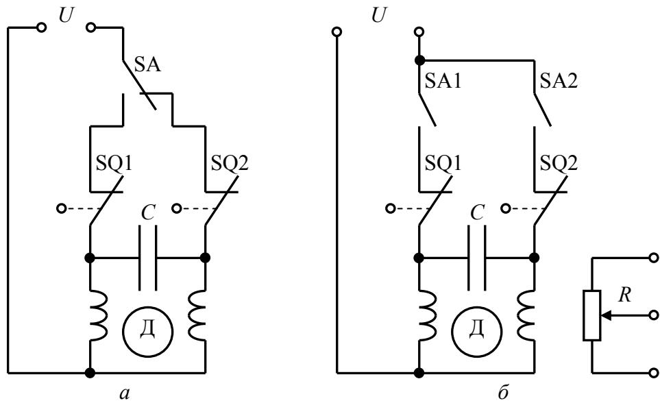
Рис. 2.53. Схемы ИМ с двухфазными электродвигателями:
