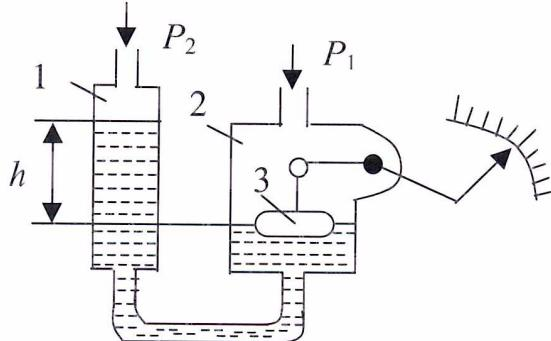
Рис. 4.10. Схема поплавкового дифманометра
