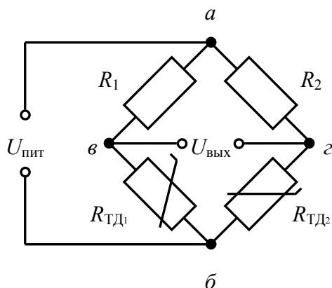
Рис. 2.11. Схема включения двух тензодатчиков в мост
