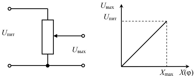
Рис. 2.4. Потенциометрическая схема включения датчика и его характеристика
