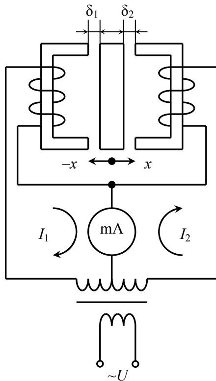
Рис. 2.15. Дифференциальный индуктивный датчик, включенный в дифференциальную схему
