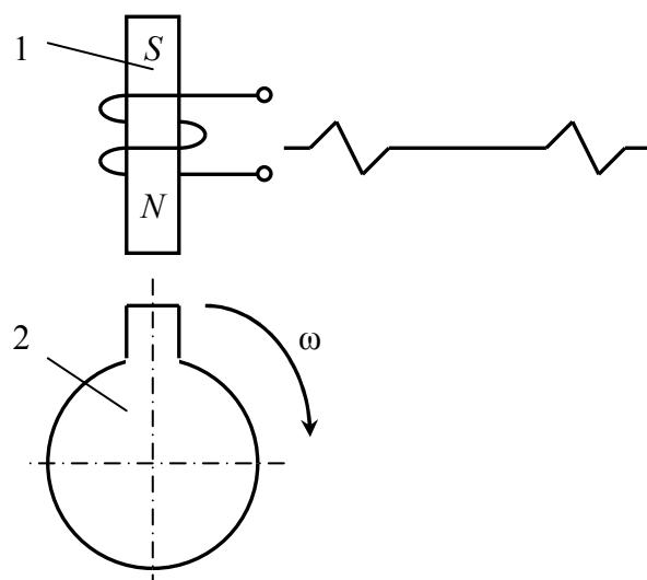
Рис. 2.24. Индукционный датчик частоты вращения
