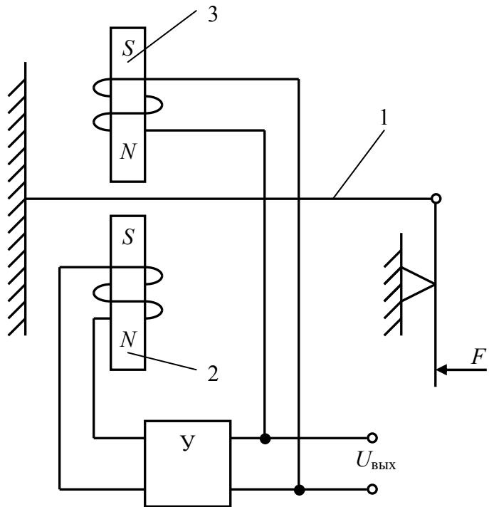
Рис. 2.26. Струнный датчик силы
