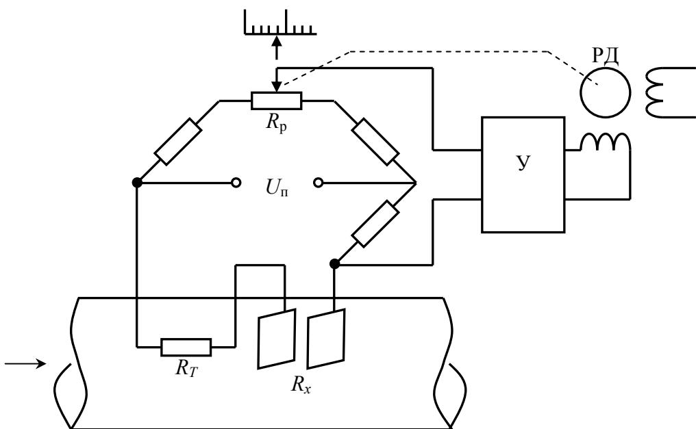
Рис. 4.31. Схема измерения солесодержания
