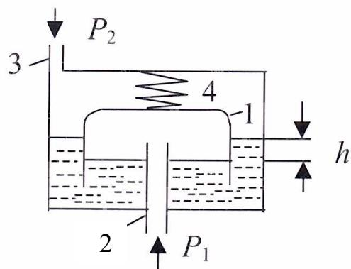
Рис. 4.9. Схема колокольного дифманометра
