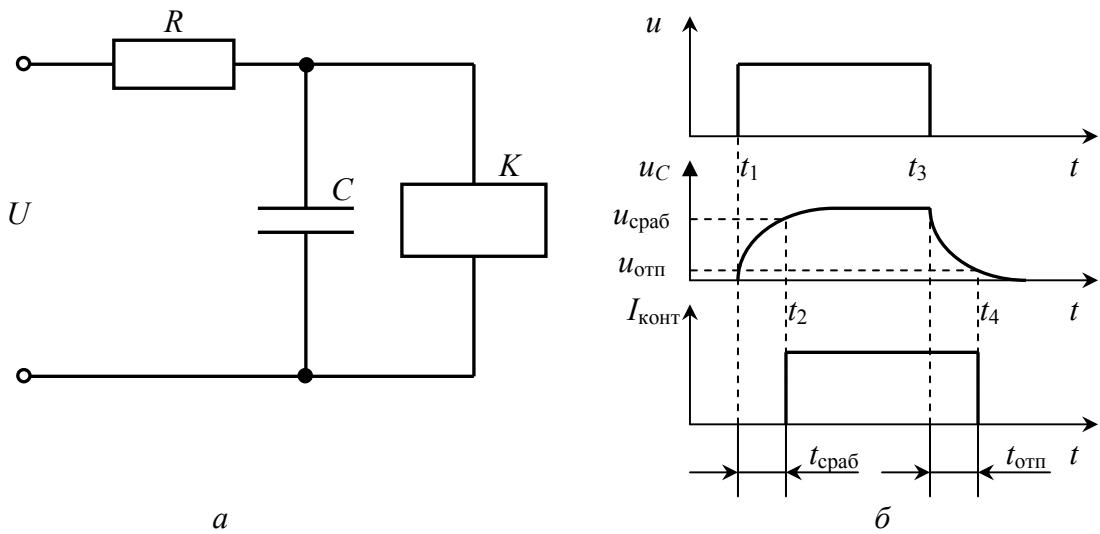
Рис. 2.39. Схемный способ реализации реле времени:
