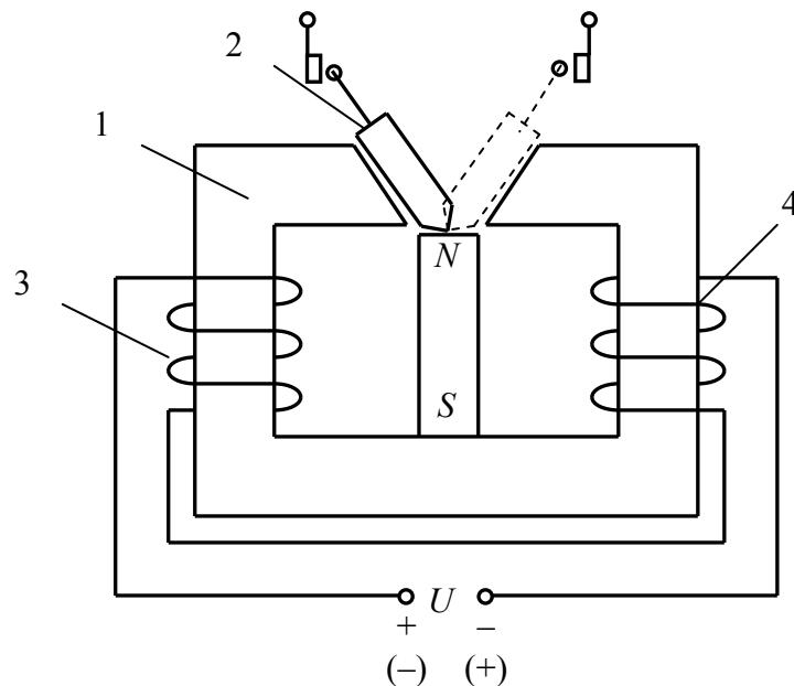
Рис. 2.32. Поляризованное электромагнитное реле:
