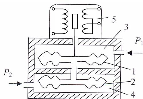
Рис. 4.14. Мембранный дифманометр
