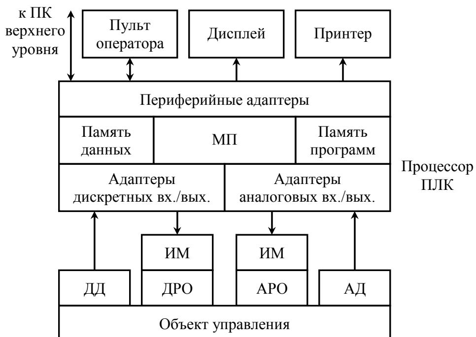
Рис. 5.10. Структурная схема САР с ПЛК
