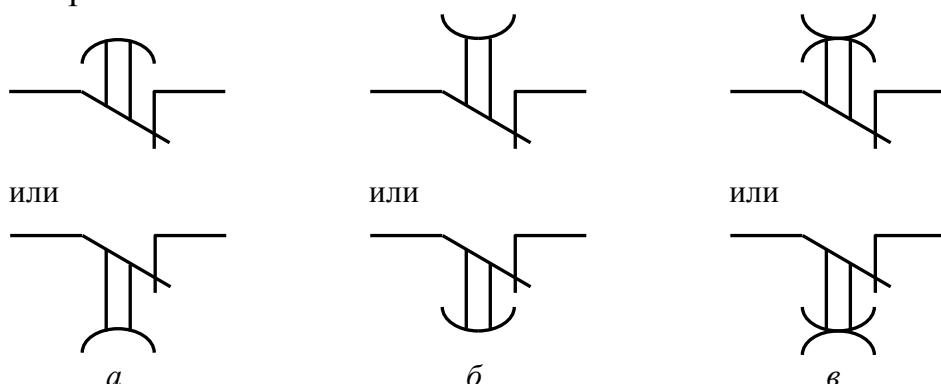
Рис. 2.42. Условные графические обозначения размыкающих контактов реле времени:
