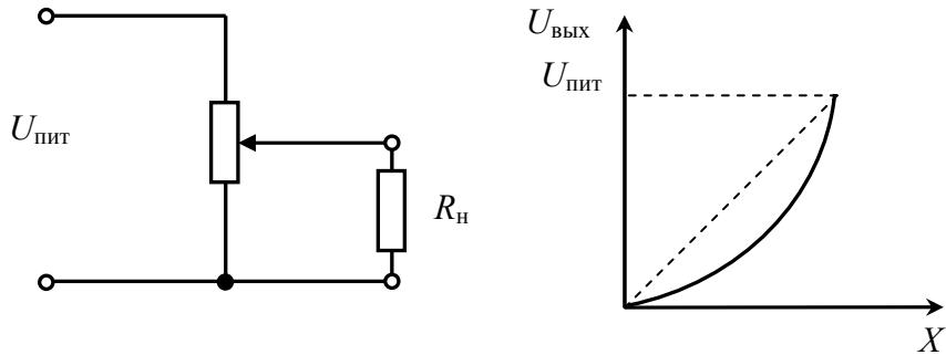
Рис. 2.5. Схема нагруженного датчика и его характеристика
