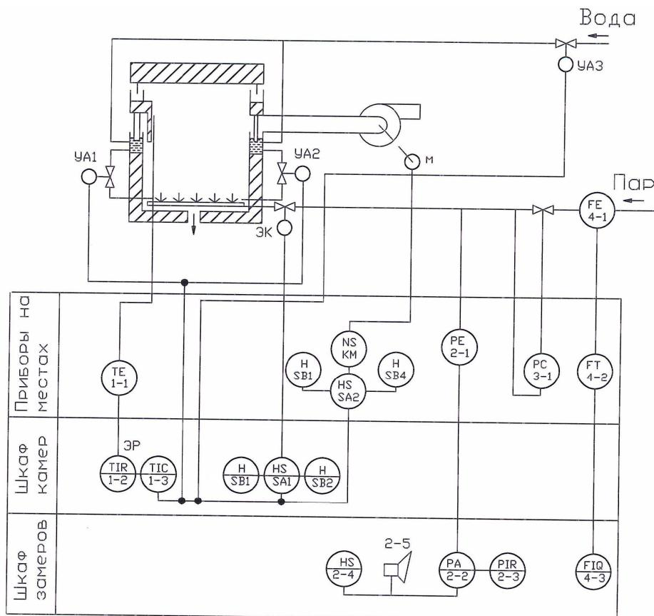
Рис. 6.22. Функциональная схема автоматизации пропарочной камеры
