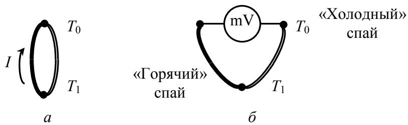
Рис. 4.7. Термопары: *a* – контур из двух разнородных проводников; *б* – схема подключения милливольтметра
