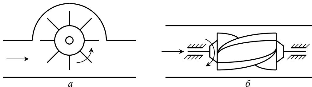
Рис. 4.18. Схема тахометрического преобразователя расходомера:
