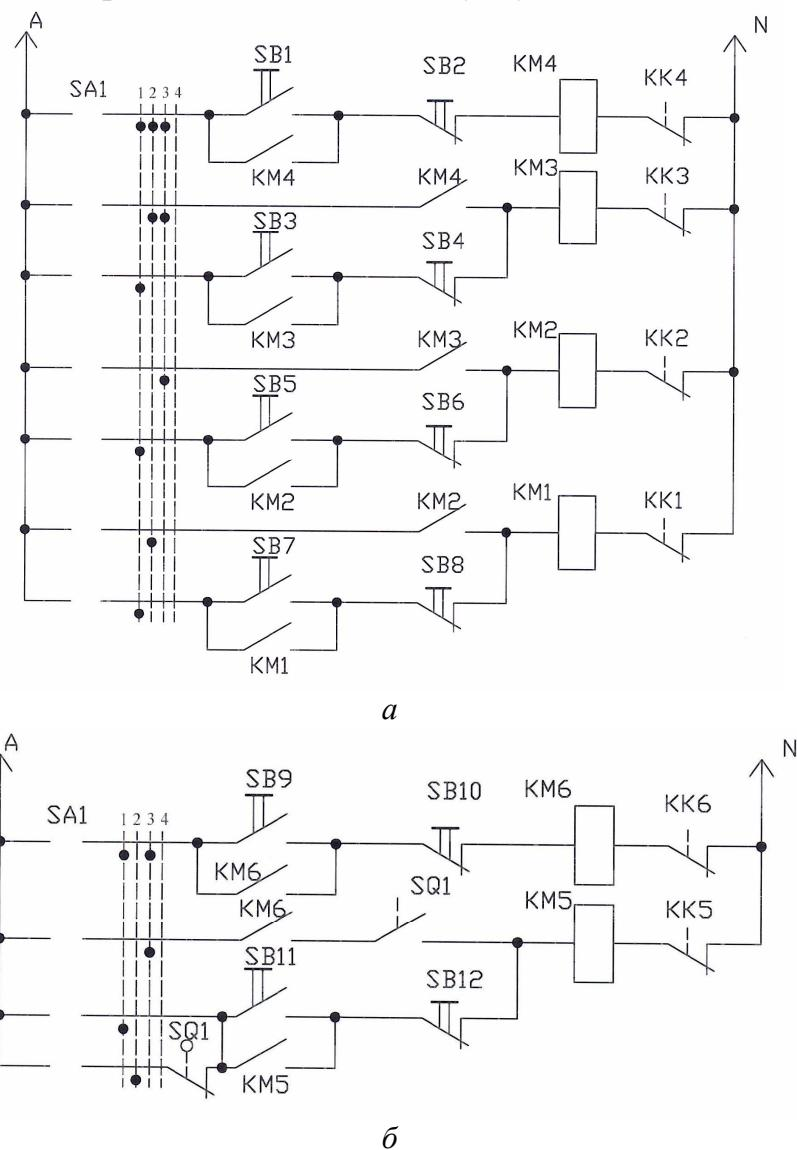
Рис. 6.8. Схема системы управления транспортерами:
