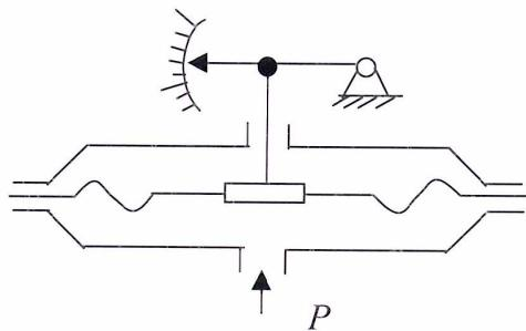
Рис. 4.13. Мембранный манометр
