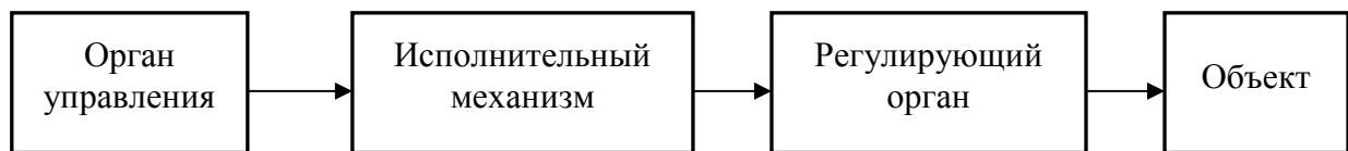
Рис. 1.2. Структурная схема системы дистанционного управления
