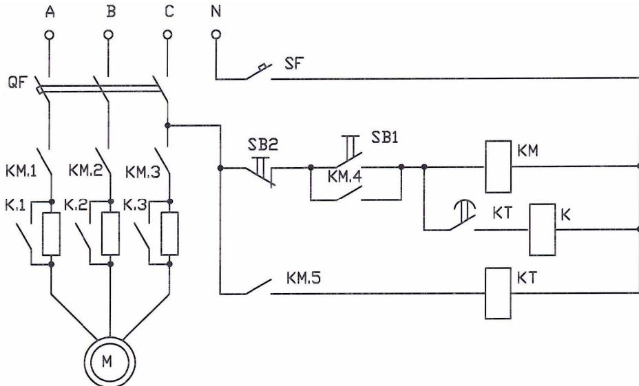
Рис. 6.3. Схема пуска электродвигателя с ограничением пускового тока
