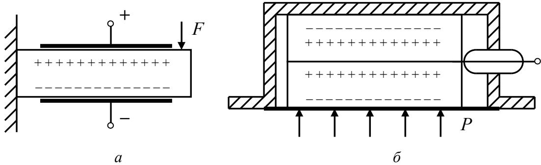
Рис. 2.22. Пьезоэлектрические преобразователи: *а* – силы; *б* – давления
