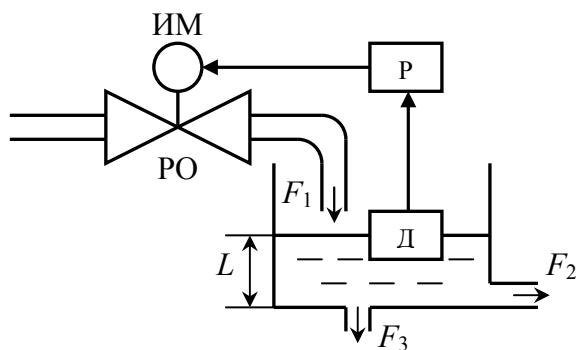
Рис. 5.5. САР уровня с регулированием по отклонению
