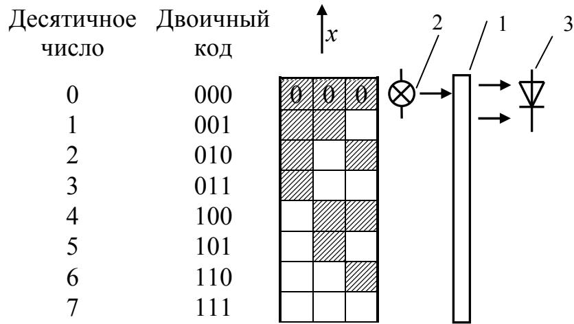
Рис. 2.27. Цифровой датчик перемещения с кодирующей маской
