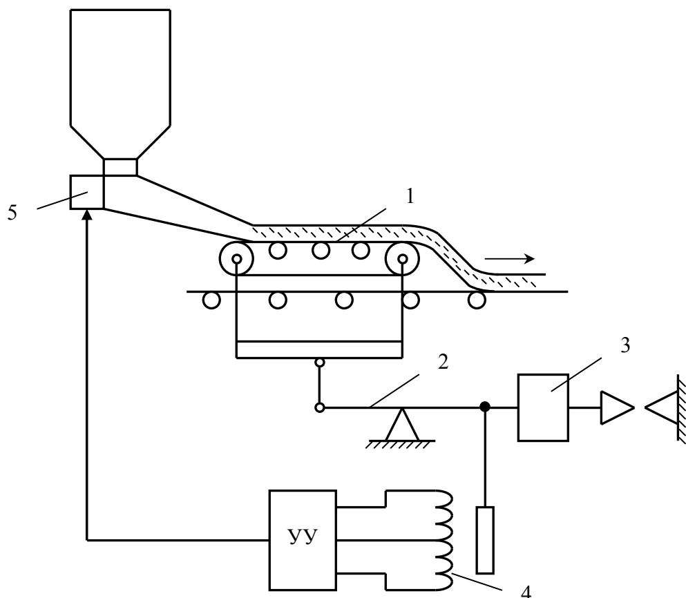
Рис. 6.14. Дозатор непрерывного действия для сыпучих материалов
