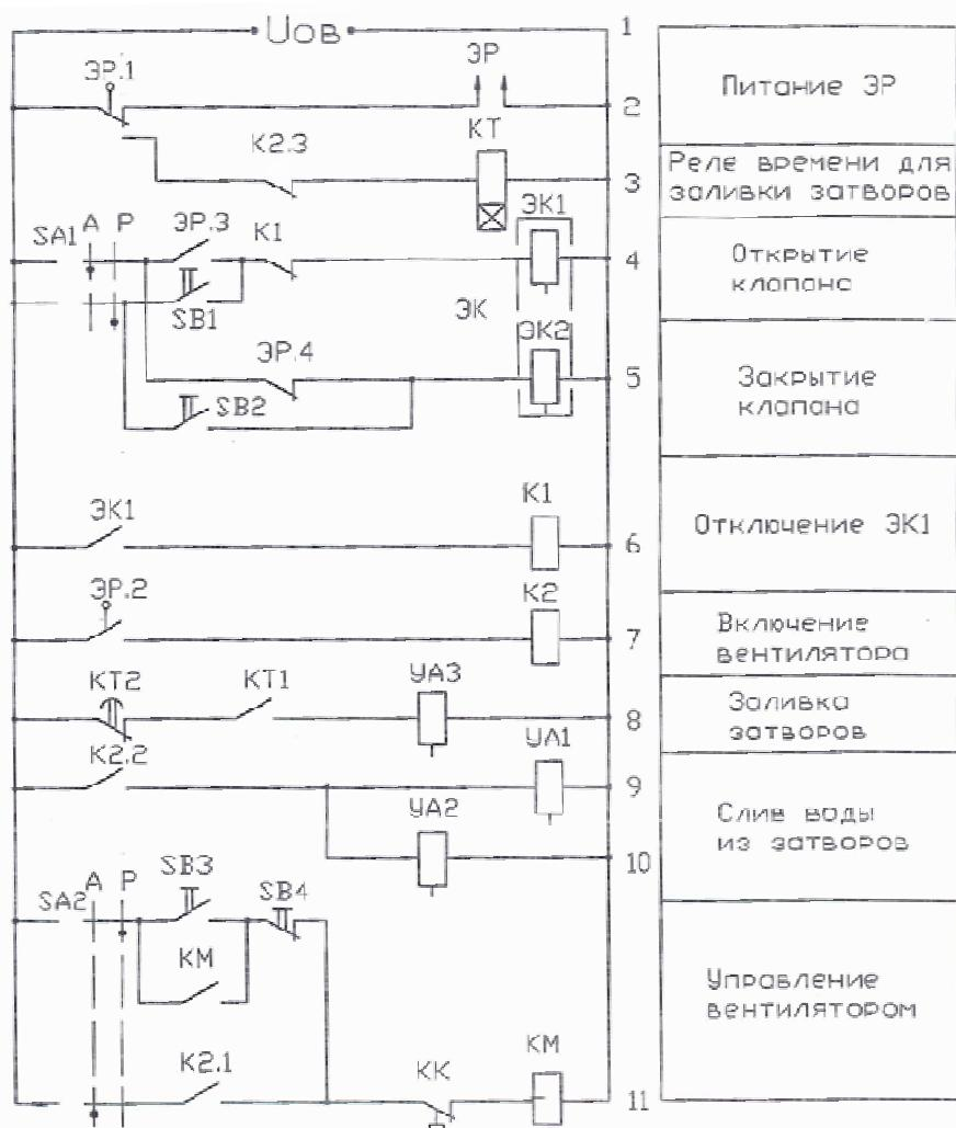
Рис. 6.23. Электрическая принципиальная схема управления пропарочной камерой
