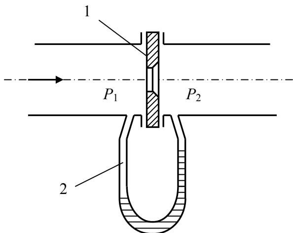
Рис. 4.16. Принцип действия расходомера с переменным перепадом давления:
