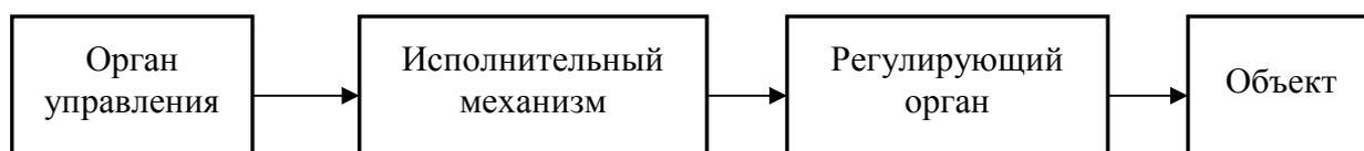
Рис. 1.2. Структурная схема системы дистанционного управления
