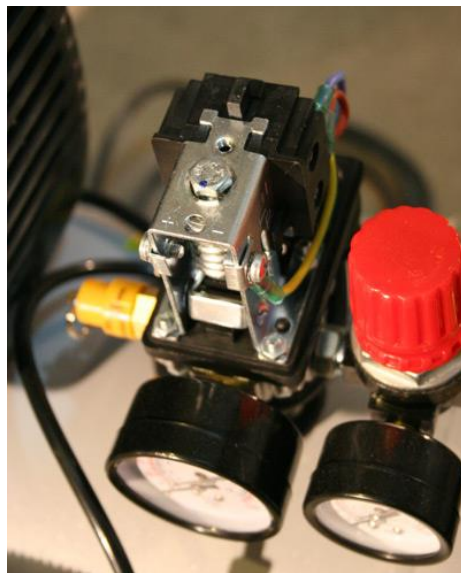
Рис. 110 Болт для регулировки порога отключения компрессора
