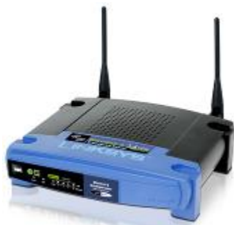
Рис. 26 Маршрутизатор Linksys WRT54G, успешно работающий мастером 1-wire сети
