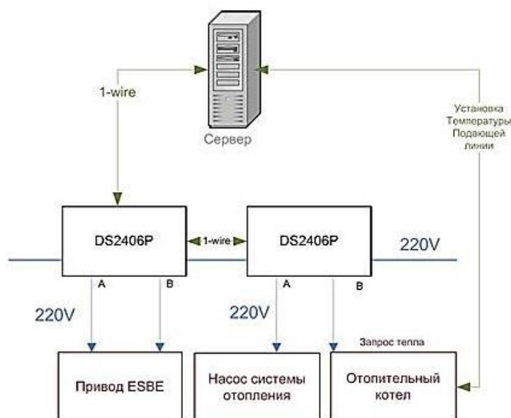
Рис. 51 Схема управления отоплением с помощью модулей 1-wire
