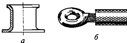
Рис. 8.15. Кольцевой наконечник ( а ) и конец многопроволочной медной жилы, опрессованный кольцевым наконечником ( б )
