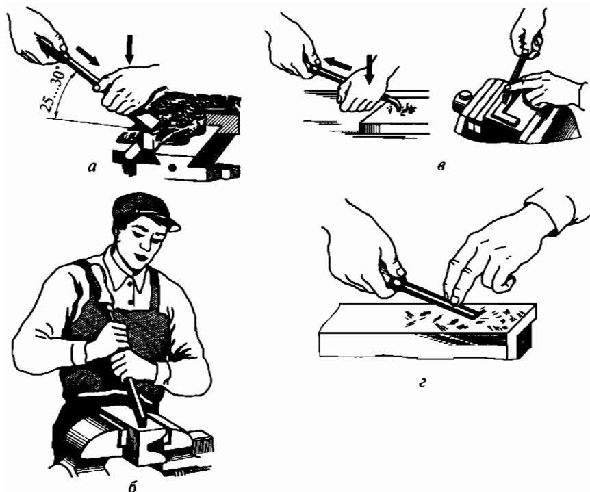
Рис. 4.35. Шабрение плоских деталей «от себя» (а) и «на себя» (б), шабрение канавок (в), выполнение отделочных операций(г)
